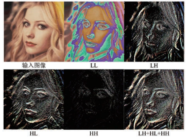
图 6 Haar 小波变换 [22] 后的频率分量示意图
