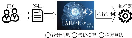
图 2 基于 AI 的查询优化器执行计划生成流程
